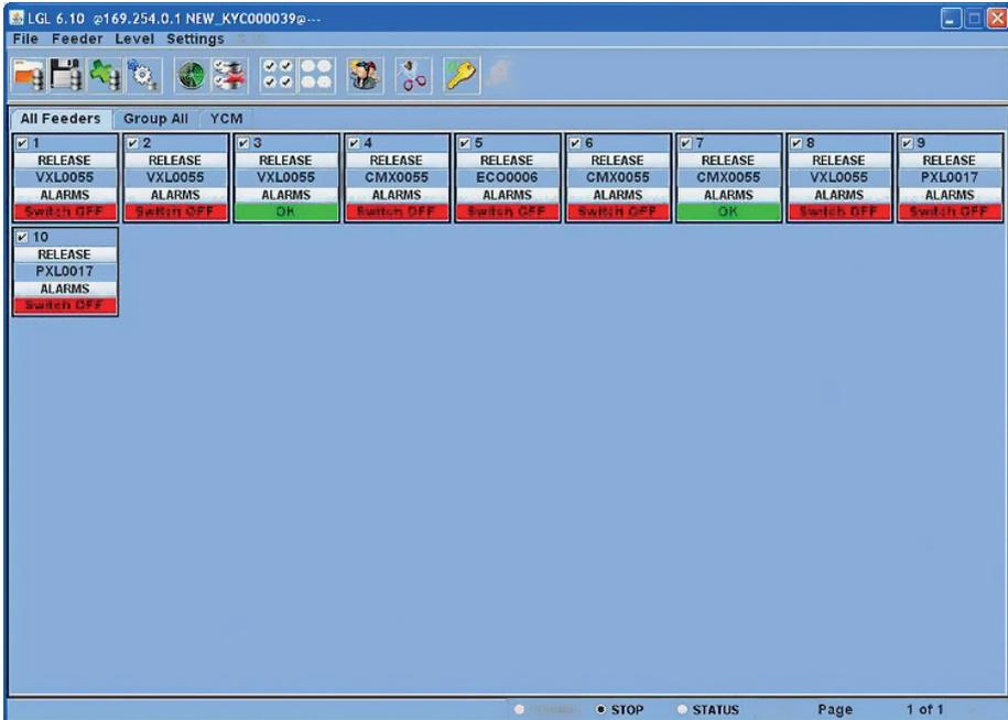
ONGLET STATUT situé en bas de l'écran : surveillance de l'alarme en mode continu. Cette fonctionnalité est nécessaire si l'ordinateur est éloigné de la machine, afin d'être en mesure d'avoir des informations sur les alarmes possibles sans être aux commandes de la machine. Si une alarme se déclenche pendant que la machine est en marche et que l'onglet STATUT est sélectionné, le chargeur arrêtera la machine et une mention.
