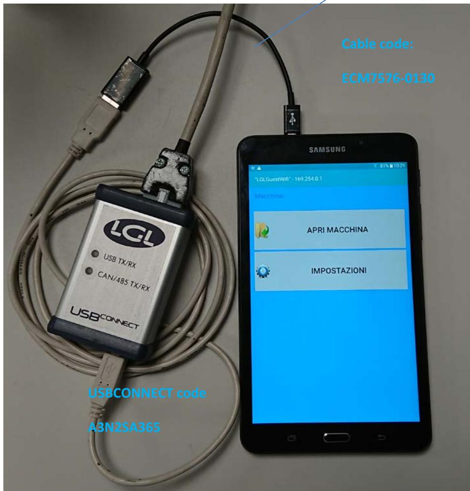
HINWEIS: Das USBCONNECT-Gerät funktioniert nur mit einem USB-Kabel.
