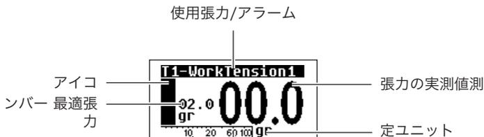
張力表示バー — このバーでは、最大張力を示す部分からの平均糸張力を表示します。
